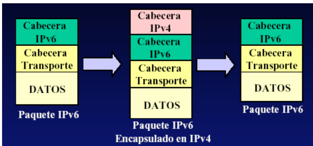
Figura 10. Túnel IPv6 encapsulado en IPv4
