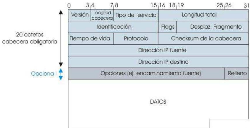
Figura 1. Estructura de un paquete IPv4
