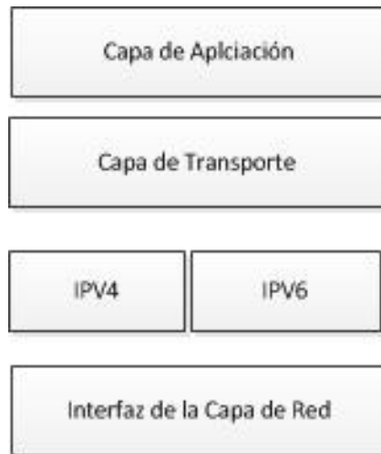
Figura 7. Pila dual IPv4 e IPv6
