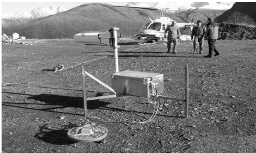
Figura 24. El spider es un instrumental que ayuda a la colocación de las cajas con los sensores mediante helicópteros
